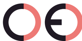
Faux marquage CE (trop éloigné)
